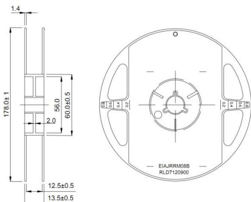
使用方向及尺寸 Progressive direction and Dimensions:
