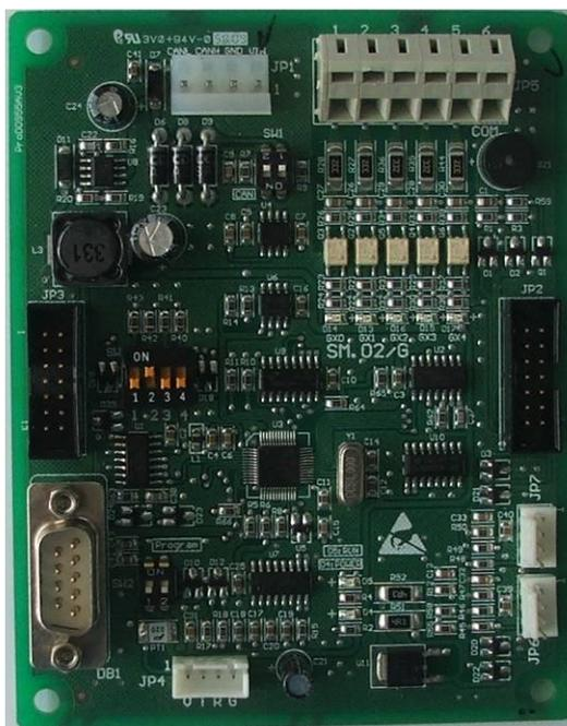
图 6.7 轿厢控制板外形图
