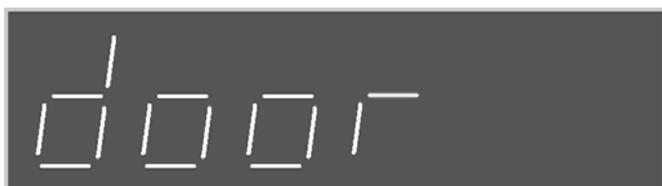
当参数 F165 (开关门控制) 的 Bit3 位设为 1 时, 就开通了 LED 操作器开关门的功能, 在此界面下按 F1 键系统会输出开门信号, 按下 F2 键系统会输出关门信号。
