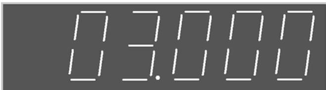
该参数显示楼层的井道数据以及平层插板的长度、平层开关距离、减速开关的位置。
