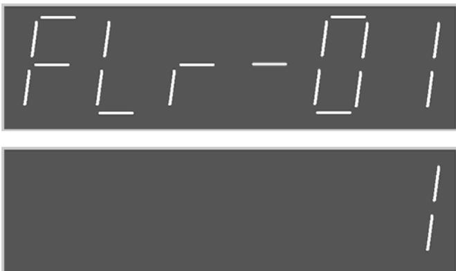
该参数设置每一层的楼层显示代码。具体操作如下：使用“上”“下”按键选择要浏览的楼层。比如 1 楼，屏幕上会显示如上图的“FLr-01”，等待一秒钟后，屏幕显示该层的显示代码，1，如上图，你将看到“1”。之后，“FLr-01”和“1”交替显示，每个约持续一秒钟。按下“Enter”，LED 的最低一位开始闪烁，使用“上”“下”按钮选择该位的数字。使用“左”“右”按钮选择需要输入数字的位，被选中的一位将闪烁，表示进入数字输入状态，再次通过“上”“下”按钮选择需要输入的数字，按下“Enter”键，完成参数修改，被选中的位停止闪烁。
