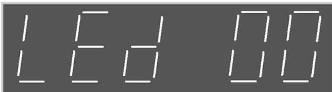
使用“上”“下”按钮, 选择 18 个 LED 指示灯 L1~L18 的含义代码, 按下“Enter”确定, 则
