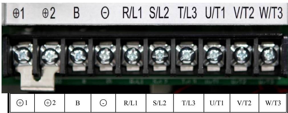
图 4.6 主回路端子的排列图
