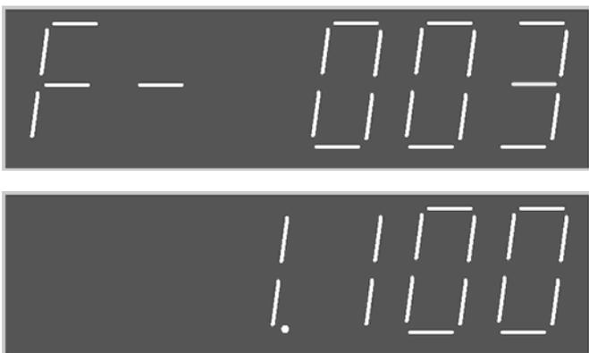
由于 F 参数较多，参数的序号要用 3 位数显示。并且，参数本身也需要多位数字显示。故在设计时采用了特别的处理方式，使用交替显示的方式来显示 F 参数。具体操作如下：使用“上”“下”按键选择要浏览的参数。比如 F3，屏幕上会显示如上图的“F-003”，等待一秒钟后，屏幕显示 F3 参数的数值，1.100，如上图，你将看到“1.100”。之后，“F-003”和“1.100”交替显示，每个约持续一秒钟。按下“Enter”，LED 的最低一位开始闪烁，使用“上”“下”按钮选择该位的数字。使用“左”“右”按钮选择需要输入数字的位，被选中的一位将闪烁，表示进入数字输入状态，再次通过“上”“下”按钮选择需要输入的数字，按下“Enter”键，完成参数修改，被选中的位停止闪烁。
