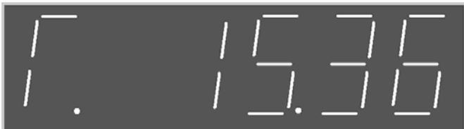
上图显示的含义是：15点36分。“T”是Time的缩写。请注意，由于七段码的限制，一体机中“T”均如上图所示。当需要修改时，按下“Enter”键，最低位的数字开始闪烁。使用“左”“右”键选择需要改动的数位，被选中的那一位会开始闪烁。再通过“上”“下”键修改数字，按下“Enter”确认修改。
