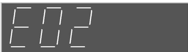
此菜单显示一体机控制部分的程序版本号。等待一秒钟后，屏幕显示控制部分的程序版本 E02，如上图，之后，“VER2”和“E02”交替显示，每个约持续一秒钟。
