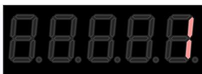
该参数设置每一层的楼层显示代码。具体操作如下：使用“上”“下”按键选择要浏览的楼层。比如 1 楼，屏幕上会显示如上图的“FLr-01”，等待一秒钟后，屏幕显示该层的显示代码，1，如上图，你将看到“1”。之后，“FLr-01”和“1”交替显示，每个约持续一秒钟。按下“Enter”，LED 的最低一位开始闪烁，使用“上”“下”按钮选择该位的数字。使用“左”“右”按钮选择需要输入数字的位，被选中的一位将闪烁，表示进入数字输入状态，再次通过“上”“下”按钮选择需要输入的数字，按下“Enter”键，完成参数修改，被选中的位停止闪烁。
