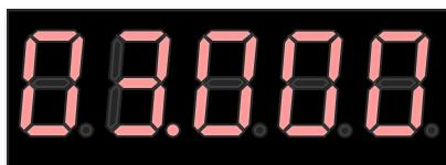
该参数显示楼层的井道数据以及平层插板的长度、平层开关距离、减速开关的位置。
