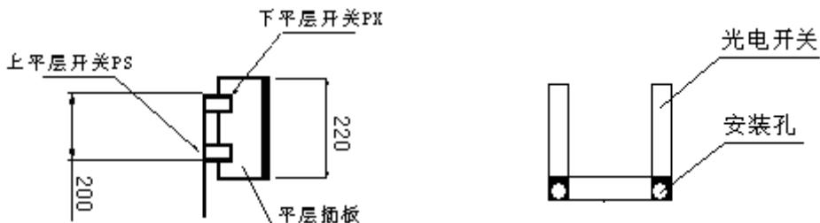
图 8.8 平层开关安装标准
