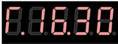
上图显示的含义是：16 点 30 分。“T”是 Time 的缩写。请注意，由于七段码的限制，一体机中“T”均如上图所示。当需要修改时，按下“Enter”键，最低位的数字开始闪烁。使用“左”“右”键选择需要改动的数位，被选中的那一位会开始闪烁。再通过“上”“下”键修改数字，按下“Enter”确认修改。
