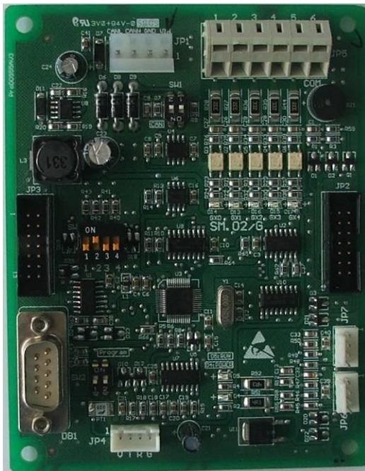
图 6.7 轿厢控制板外形图
