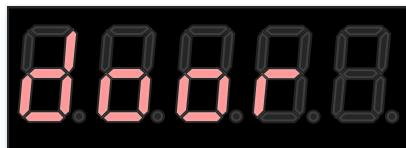
当参数 F165（开关门控制）的 Bit3 位设为 1（0x8 开通）时，就开通了 LED 操作器开关门的功能，在此界面下按向上键系统会输出开门信号，按下向下键系统会输出关门信号。
