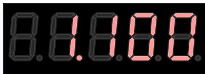
由于 F 参数较多，参数的序号要用 3 位数显示。并且，参数本身也需要多位数字显示。故在设计时采用了特别的处理方式，使用交替显示的方式来显示 F 参数。具体操作如下：使用“上”“下”按键选择要浏览的参数。比如 F3，屏幕上会显示如上图的“F-003”，等待一秒钟后，屏幕显示 F3 参数的数值，1.100，如上图，你将看到“1.100”。之后，“F-003”和“1.100”交替显示，每个约持续一秒钟。按下“Enter”，LED 的最低一位开始闪烁，使用“上”“下”按钮选择该位的数字。使用“左”“右”按钮选择需要输入数字的位，被选中的一位将闪烁，表示进入数字输入状态，再次通过“上”“下”按钮选择需要输入的数字，按下“Enter”键，完成参数修改，被选中的位停止闪烁。
