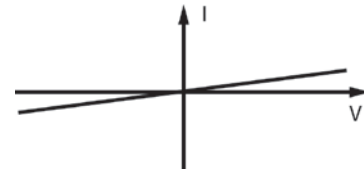
图 2: 纯电阻样品的 I-V 曲线
