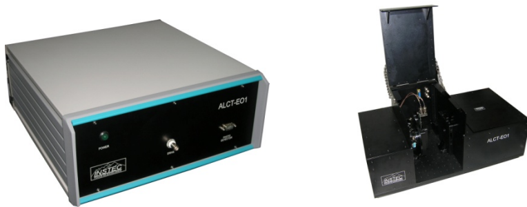
电气设备 (上左图) 和透射率测试设备 (上右图) (K22 测量用)
