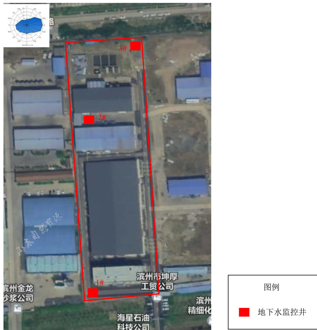
图 6.4-4 厂区地下水监控井分布图
