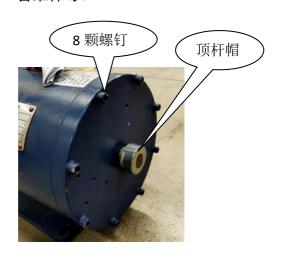
注: SHB 型制动器外观必须如上图所示,具体特点: 1、每边端盖上有 8 颗内六角螺钉(如图),左右即有 16 颗; 2、顶杆帽如图所示,具体铭牌型号见下表:
