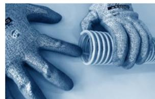
Litze zwecks Erdung zum Beispiel in den Schlauch biegen und den Schlauch auf einem elektrisch leitfähigen und metallisch geerdeten Stutzen montieren.
