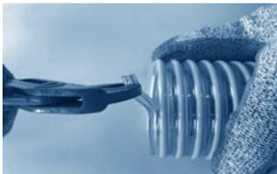
Schritt 4: Eingeschnittene Schlauchwandung mit Zange fassen und solange kräftig ziehen, bis die Erdungslitze aus der Kunststoffwandung heraustritt.
