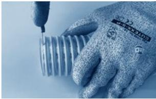
Schritt 3: ¼ Umfang der Schlauchwandung entlang der Hartkunststoffwendel neben der Litze so einschneiden, dass die Litze in der nun abgeschnittenen Schlauchwandung liegt.
