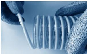
Schritt 2: Anschließend die abgeschnittene Hartkunststoffwendel mit dem Seitenschneider abkneifen.
