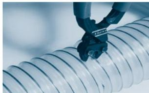
Schritt 2: Stützwendel mittels Zange durchtrennen.
