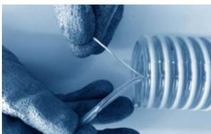
Schritt 5: Erdungslitze und Kunststoffwandung durch Ziehen mit den Fingern vorsichtig voneinander trennen. Loses Ende der Kunststoffwandung mit dem Seitenschneider abkneifen.
