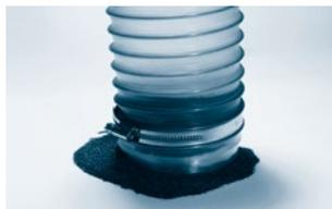
Deutliche Leckage bei Verwendung herkömmlicher Schlauchschellen.
