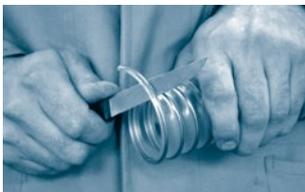
Schritt 1: Schlauch entlang dem Stahldraht mit einem gezahnten Messer einschneiden.
