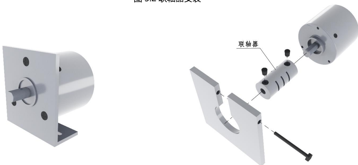
图 3.3 支架、联轴器安装
