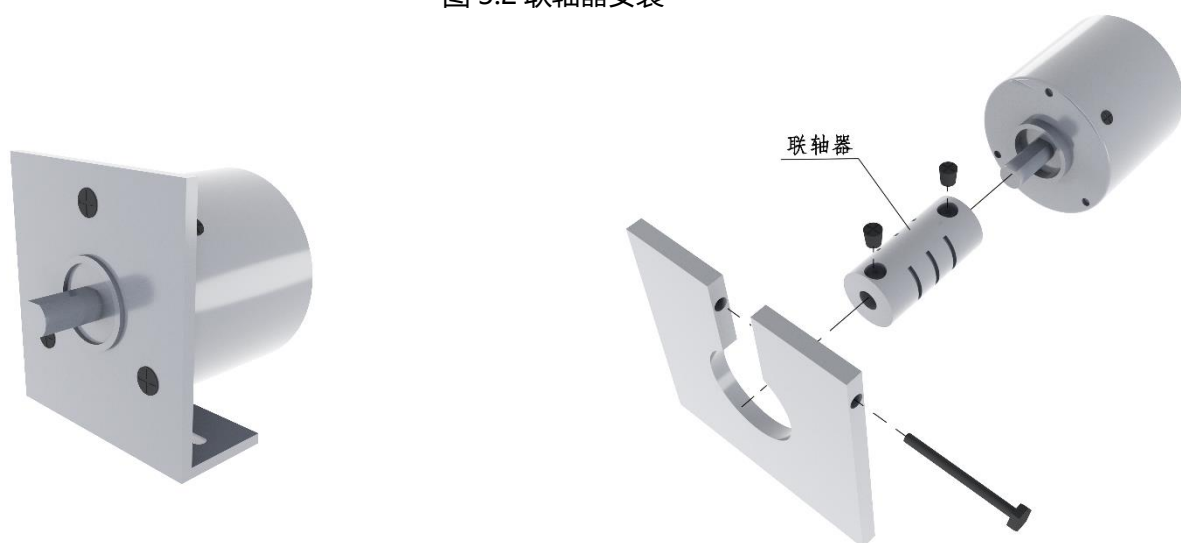
图 3.3 支架、联轴器安装
