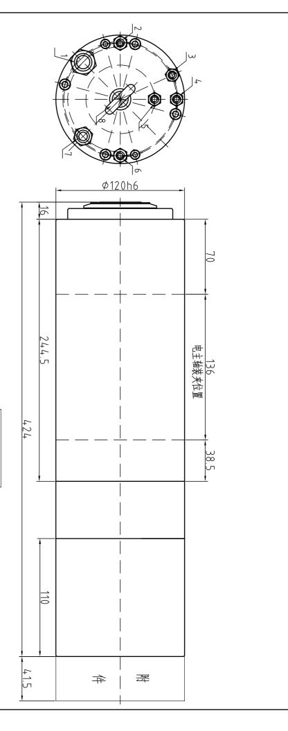
4:气封压力 2:冷却出水 1:电源线 6:冷却进水 5:卸刀进气压力 3:换刀除尘压力 7:接近开关数量 温度控制线 接近开关接法 信号负载—端接+24 VDC/另—端接黑线 0.70MPa (6/4執管) 0.2-0.3MPa (6/4教管) 0.1-0.2MPa(6/4教管) 挂刀与卸刀两个NPN(常开)N.Ο. 三色线接U、V、W相/黄绿线接地 棕线接+24VDC 蓝线接0VDC 水泵扬程12m (不要接错!) 110℃热敏电阻二相接温控保护器 (2与6端接8/6執管)
