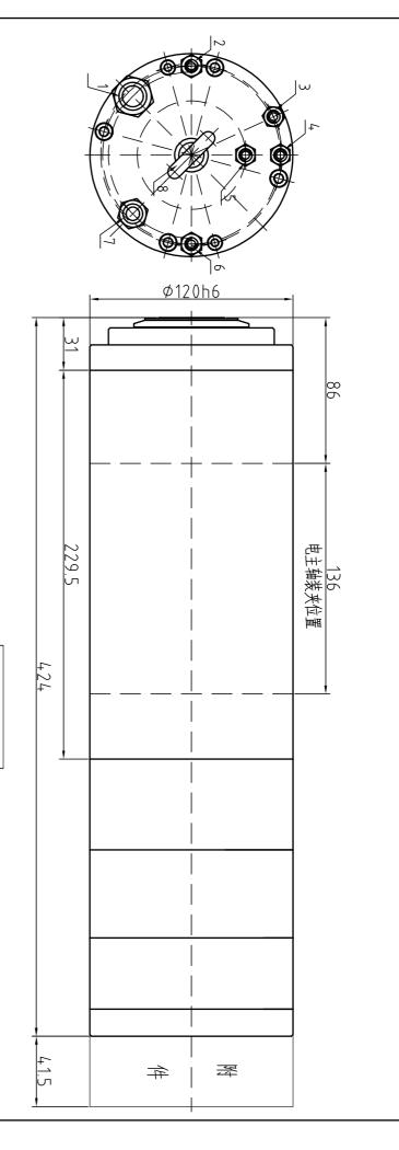
2:冷却出水 5:卸刀进气压力 0.70MPa (6/4教管) 水形库公:9 4:气封压力 3:换刀除尘压力 温度控制线 0.2-0.3MPa (6/4软管) 0.1-0.2MPa (6/4報管) 水泵扬程12m (不要接错!) 三色线接U、V、W相/黄绿线接地 110℃热敏电阻二相接温控保护器 (2与6端接8/6软管)
